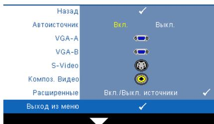
**Автоисточник**—Чтобы заблокировать текущий источник входного сигнала, выберите **Выкл.** (значение по умолчанию). При нажатии кнопки **Источник**, если для режима **Автоисточник** установлено значение **Выкл.**, можно выбрать источник входного сигнала вручную. Для автоматического определения доступных источников сигнала выберите **Вкл.** При нажатии кнопки
