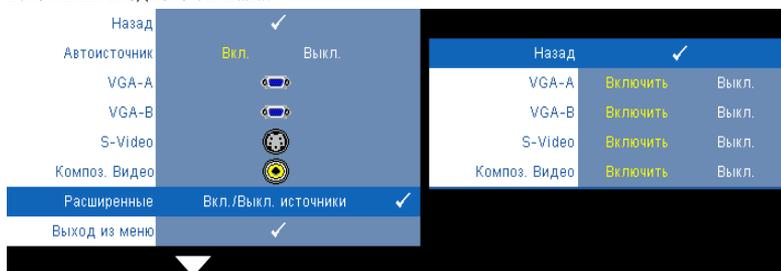
**VGA-A**—С помощью кнопок  и  можно включать и отключать входной сигнал VGA-A.
