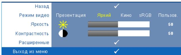
**Режим видео**—Оптимизация отображенного изображения. **Презентация**, **Яркий**, **Фильм**, **sRGB** (более точная цветопередача) и **Пользов.** (настройка необходимых параметров).
