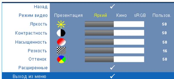
**Режим видео**—Оптимизация отображенного изображения. **Презентация**, **Яркий**, **Фильм**, **sRGB** (более точная цветопередача) и **Пользов.** (настройка необходимых параметров).
